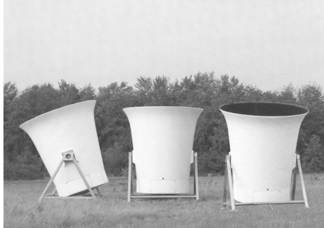
Fig. 2.63: SODAR tradizionale (Metek – GmbH)
