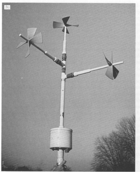
Fig.2.57: anemometro ad elica triassiale.
